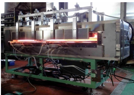
図-23:素材部分加熱炉
