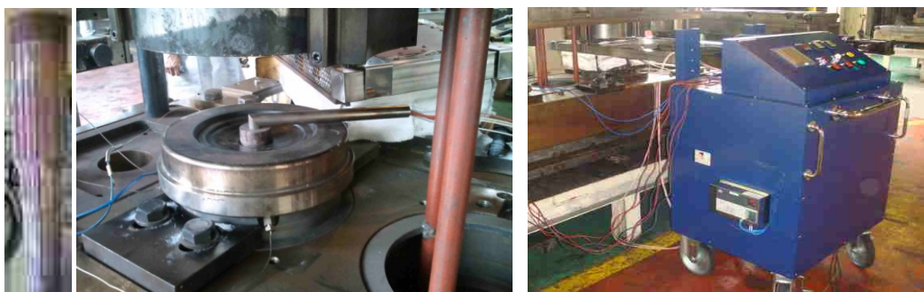
丸形金型(深部形状金型)予熱器の製作外系図及び製作予熱器
