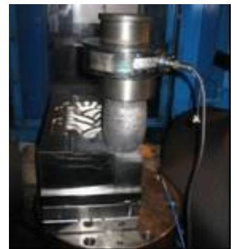
写真6 アルミ材据え込みによる事前確認試験
