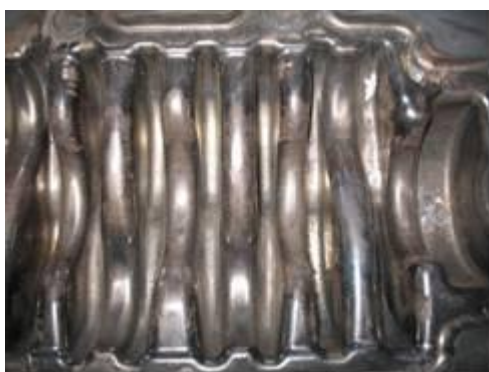
写真8 使用後の計測用金型
