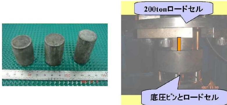
写真 11 簡易試験の様子 (左：据え込んだビレット、右：据え込み時の様子)
