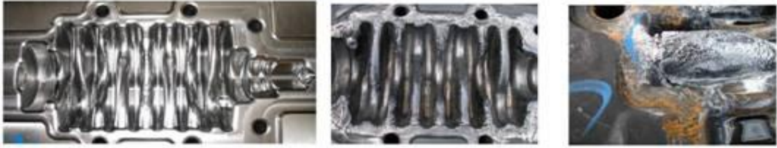
写真1 計測対象とした金型（左：新品、中：摩耗したものの、右：割れたもの）
