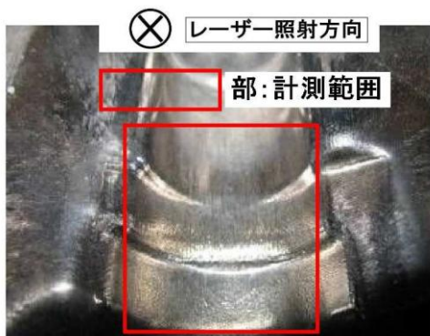
写真 13 変更した測定部位外観
