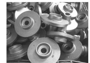
写真 スケールを除去した鍛造品
